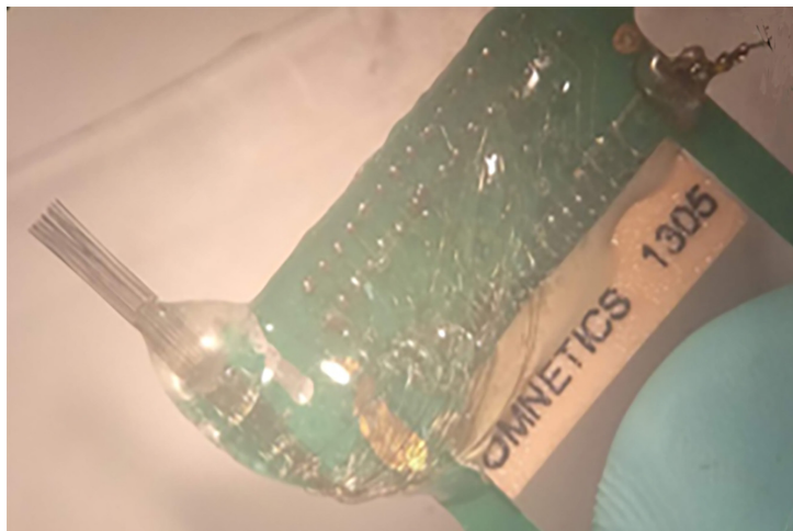
Figura 1 - Matriz de multieletródos de fios de tungstênio. Os fios de tungstênio estão distantes aproximadamente 0,2mm e formam uma matriz de 8x4 eletrodos
