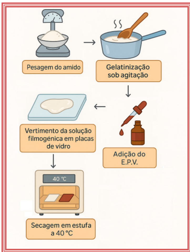
Figura 3 – Fluxograma ilustrado do processo de desenvolvimento dos filmes biodegradáveis pelo método casting
