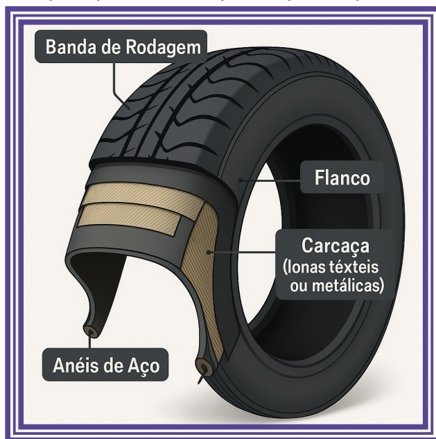
Figura 4 - Ilustração de um pneu em corte transversal destacando as principais camadas que compõem o pneu
