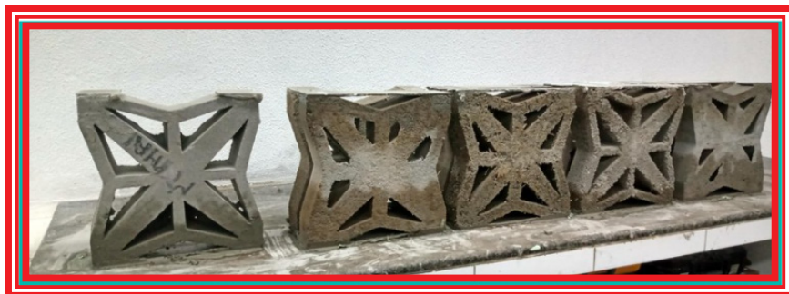
Figura 8 - Cobogós em testes metrológicos de compressão.
