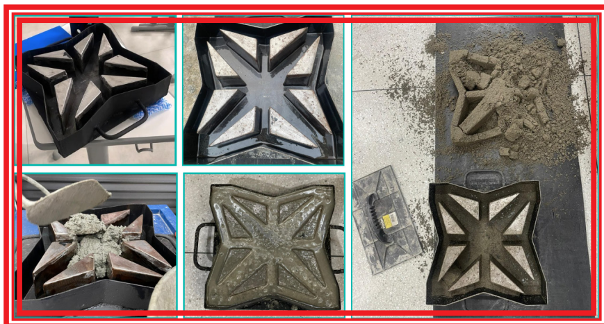
Figura 5 - Conjunto de imagens ilustrativas da chapa de ferro para criação dos protótipos.
