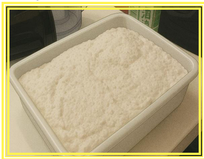
Figura 4 – Cascas imersas no ácido acético.
