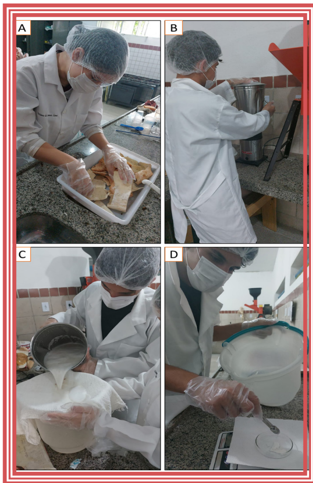
Figura 2 - Etapas da obtenção do amido a partir da casca da mandioca, A - Higienização das cascas, B - Trituração das cascas, C - Filtração, D - Amido obtido.
